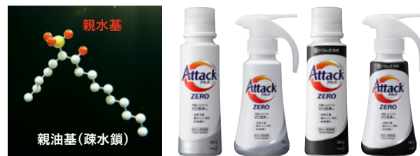
バイオ IOS 分子構造モデル 親水基:水になじむ部分、親油基(疎水鎖):油になじむ部分 長い親油基の中間部に親水基が位置する特殊な構造となっている
