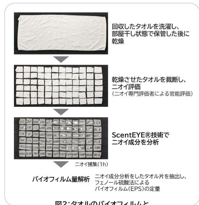
図2:タオルのバイオフィルムとニオイ成分の測定法
