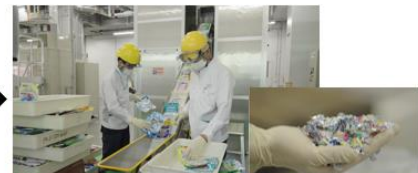
【破碎～洗浄～微粉碎】 洗浄粉碎機にて破碎後、洗 浄する。
