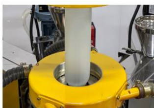
【フィルム化】 製膜機によるフィルム化。 温度最適化により、異物発生を抑制し、 リサイクル樹脂のフィルムが完成。
