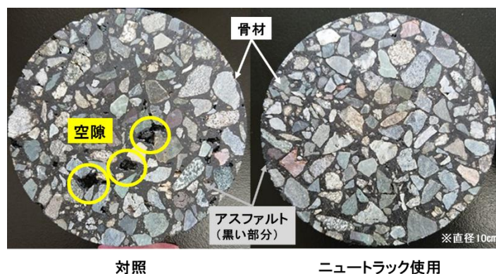
図 2. アスファルト舗装の内部の断面
