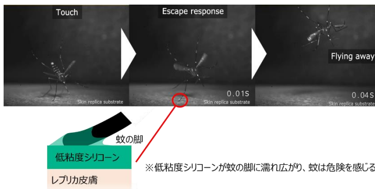
図1 低粘度シリコンオイルを塗布した表面に蚊がとどまらない様子
