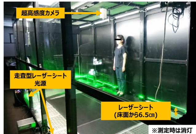
図 1. 微粒子可視化装置での試験の様子 （新日本空調株式会社 可視化専用クリーンルームにて）
