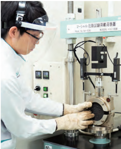
研究所におけるアスファルト改質剤の強度測定と、製品が採用された舗装工事。 わずか1%の配合で、アスファルト舗装の耐久性を約5倍に向上。
