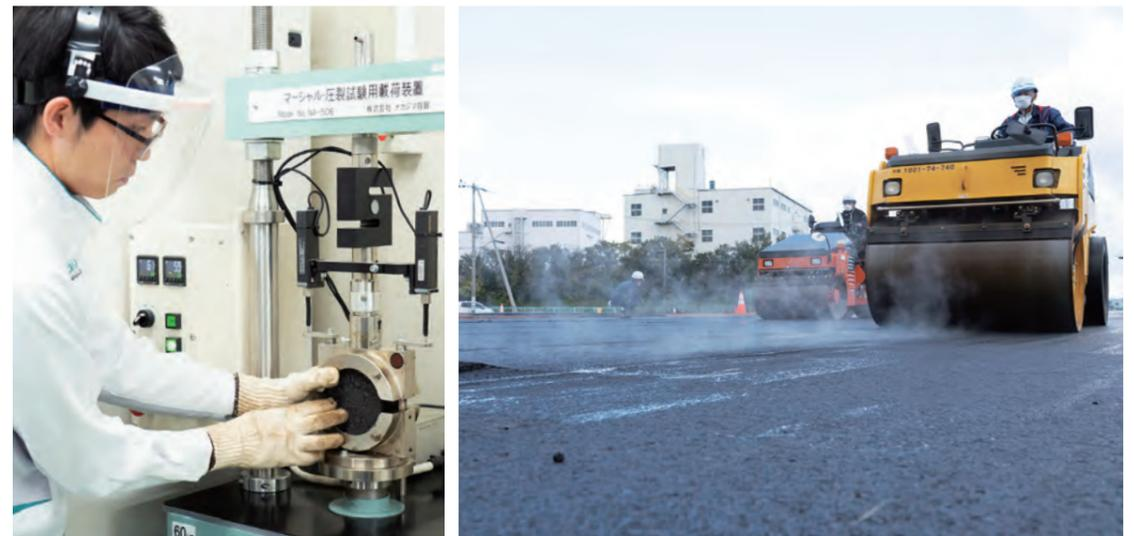
研究所におけるアスファルト改質剤の強度測定と、製品が採用された舗装工事。わずか1%の配合で、アスファルト舗装の耐久性を約5倍に向上。
