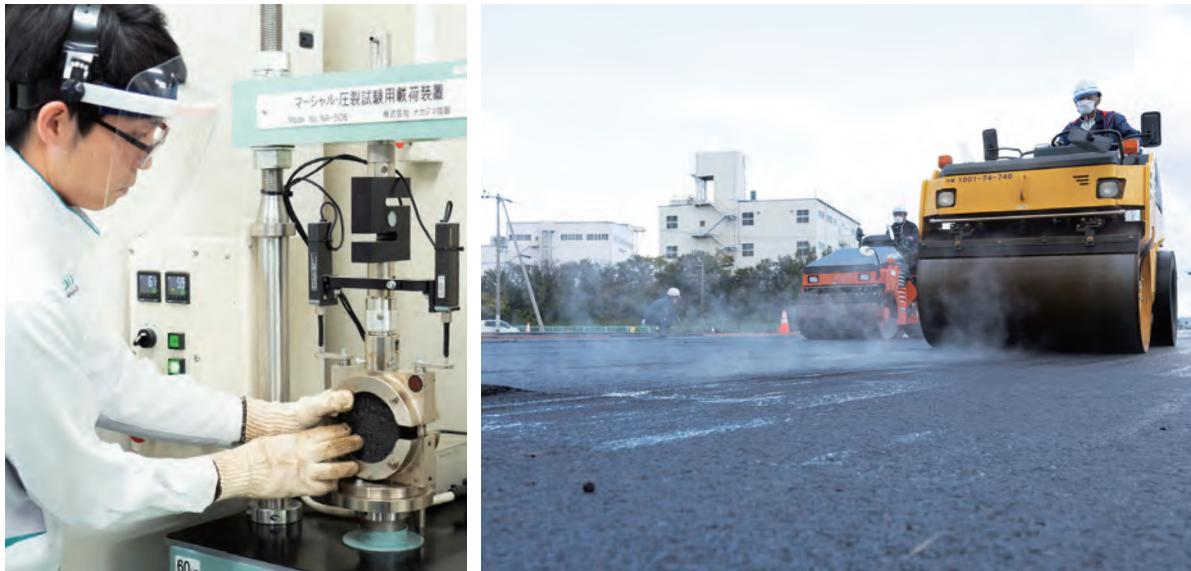
研究所におけるアスファルト改質剤の強度測定と、製品が採用された舗装工事。
