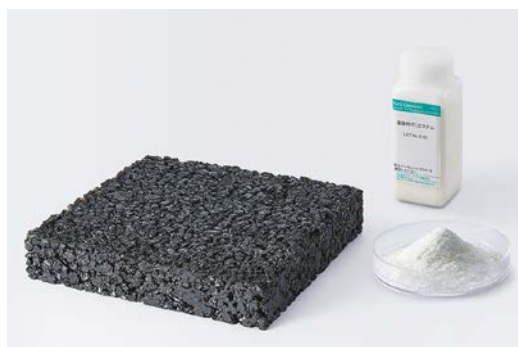
高分子機能制御技術を用いた道路用薬剤を使用したアスファルト舗装
