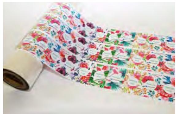
水性インクジェットプリンターで印刷されたプラスチックフィルム
